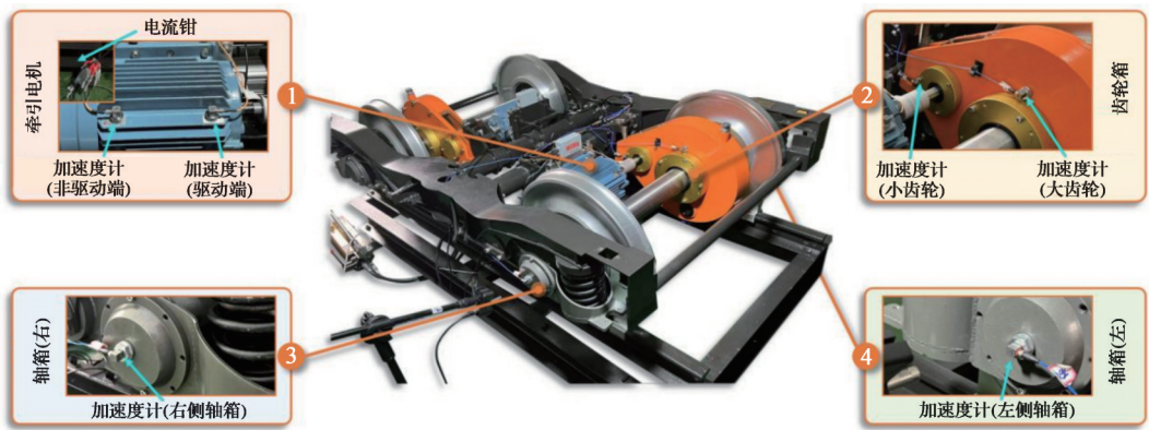
图4 地铁列车传动系统故障模拟试验台 [10]
